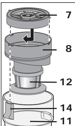
L'unité de filtration est composée : du support de filtre **8**, du filtre métallique **12** et du filtre papier **7**.
