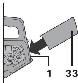
L'aspiration est impossible si la batterie n'est pas montée et chargée.
