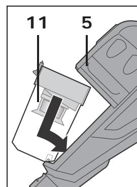
Der Staubbehälter **11** darf nur mit der kompletten Filtereinheit verwendet werden.
