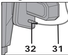
1. Stecken Sie den Netzadapter **31** in eine geeignete Steckdose und verbinden die Anschlussleitung mit dem Anschluss für den NetzadAPTER **32**.
