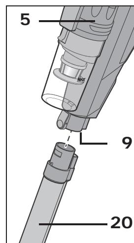
Le tube d'aspiration **20** sert de prolongateur. Toutes les parties raccordées à l'extrémité libre du tube d'aspiration peuvent également être directement enfichées dans l'orifice **9** prévu sur l'aspirateur **5**.
