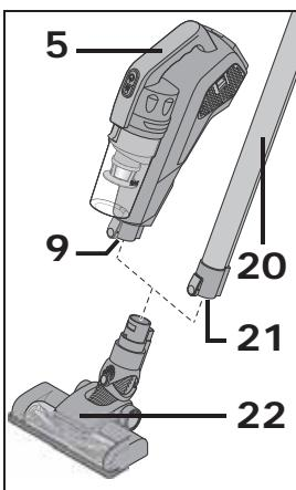
Sie können die Bodendüse **22** direkt an den Sauger **5** oder an das Saugrohr **20** montieren.
