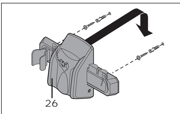
Fixez la station de base 26 sur un mur à l'aide du gabarit de perçage et du matériel de fixation fourni.
