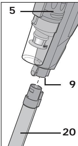
Das Saugrohr **20** dient der Verlängerung. Alle Teile, die an das freie Ende des Saugrohres angeschlossen werden, können auch direkt in die Öffnung **9** am Sauger **5** gesteckt werden.
