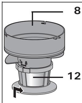
Der Metallfilter **12** befindet sich am Ende des Filterträgers **8**. Mit einer leichten Drehung kann der Metallfilter **12** gelöst und wieder aufgesetzt werden.
