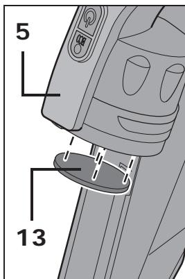
Le filtre de protection moteur **13** se situe entre le réservoir à poussière **11** et l'aspirateur **5**.
