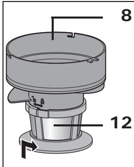
Le filtre métallique **12** se situe à l'extrémité du support de filtre **8**. Le filtre métallique **12** peut être détaché et remis en place par une légère rotation.
