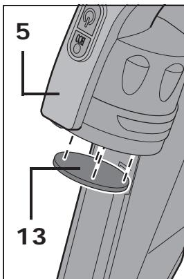
Zwischen Staubbehälter **11** und Sauger **5** befindet sich der Motorschutzfilter **13**.
