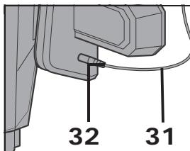
1. Branchez l'adaptateur réseau **31** dans une prise de courant adaptée et reliez le câble de raccordement directement à la prise de l'adaptateur réseau **32**.
