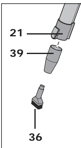
Die kleine Bürstendüse **36** wird immer mit dem Adapter **39**, verwendet.
