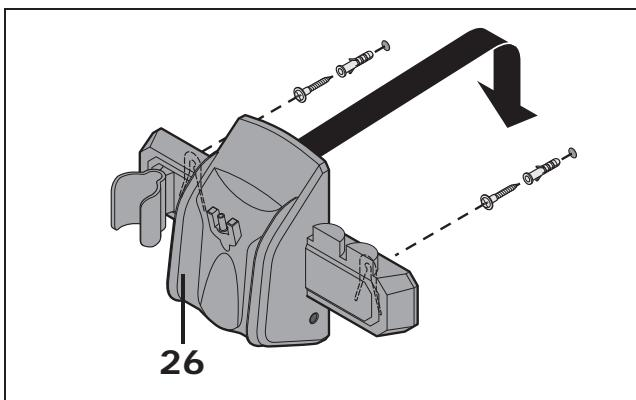
Befestigen Sie die Basisstation **26** mit Hilfe der Bohrschablone und des mitgelieferten Befestigungsmaterials an einer Wand.
