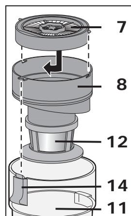
Die Filtereinheit besteht aus: dem Filterträger **8**, dem Metallfilter **12** und dem Papierfilter **7**.
